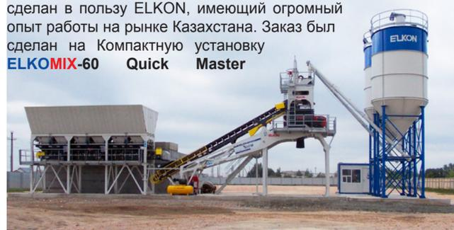
производительностью 50 куб. м уплотненного бетона в час, начало эксплуатации которой намечено на новый строительный сезон. Инертные материалы из трех отсеков бункеров будут подаваться в двухвалковый смеситель через конвейер; дробилка; дробилка; вода будет взвешиваться в оцинкованных емкостях, а два силоса по 75 тонн обеспечат необходимый для производства запас цемента. Отметим, что это уже 9-й завод ELKON в Шымкенте, а в целом по стране установлено порядка 120 БСУ ведущего турецкого бренда.
